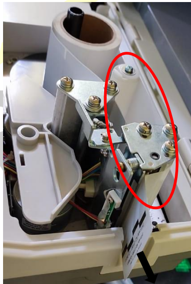
Fig. 12 – Sistema de re-embobinado del papel de respaldo.
